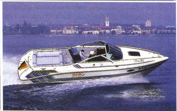
Deutlich sind auf dem großen Bild die kräftigen Längsstringer zu sehen, die den Rumpf in Gleitfahrt ein Stück aus dem Wasser liften. Darunter: das Hiltner Royal SPM 660 in Kurvenfahrt.
