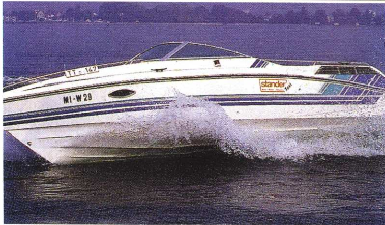
Deutlich sind auf dem großen Bild die kräftigen Längsstringer zu sehen, die den Rumpf in Gleitfahrt ein Stück aus dem Wasser liften. Darunter: das Hiltner Royal SPM 660 in Kurvenfahrt.
